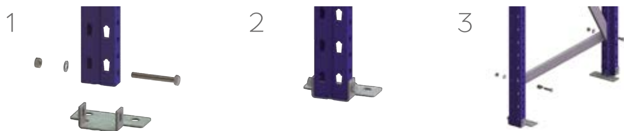
Armado de columna con base
